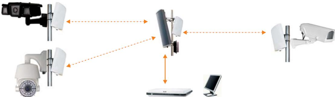
Ricetrasmisione punto-multipunto con antenne a pannello e AP (access point) separati, per la gestione bidirezionale di uno o più apparati connessi tra loro tramite uno switch di rete (es. videoregistratore, IP camera etc) , da remoto tramite un Pc o un network recorder (es. CENTER) fino a 3Km (20 con antenne direzionali o ripetitori)
