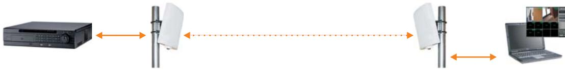
Ricetrasmisione punto-punto per la gestione bidirezionale di un apparato (esempio, videoregistratore, IP camera etc) da remoto tramite un Pc o un network recorder (es. CENTER) fino a 3 Km
