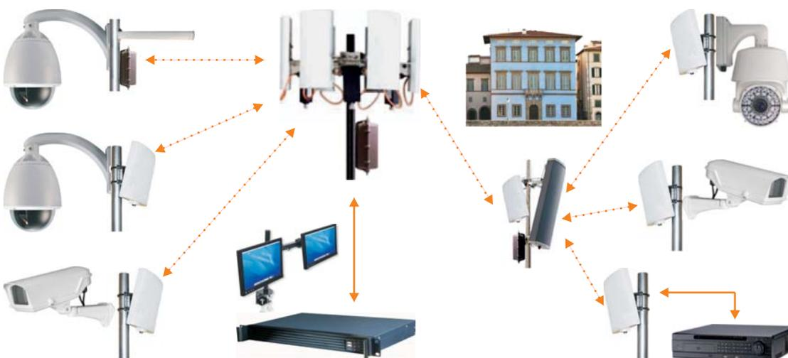
Ricetrasmisione punto-multipunto con antenne a pannello o direzionali e AP (access point) separati, per la gestione bidirezionale di uno o più apparati connessi tra loro tramite uno switch di rete (es. videoregistratore, IP camera etc) , da remoto tramite un Pc o un network recorder (es. CENTER) fino a 20 con sistema di "triangolazione" attivo per ovviare ad ostacoli visivi tra i vari apparati
