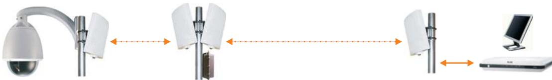
Ricetrasmisione punto-punto con ripetitore per la gestione bidirezionale di uno o più apparati connessi tra loro tramite uno switch di rete (es. videoregistratore, IP camera etc) , da remoto tramite un Pc o un network recorder (es. CENTER) oltre i 3 Km
