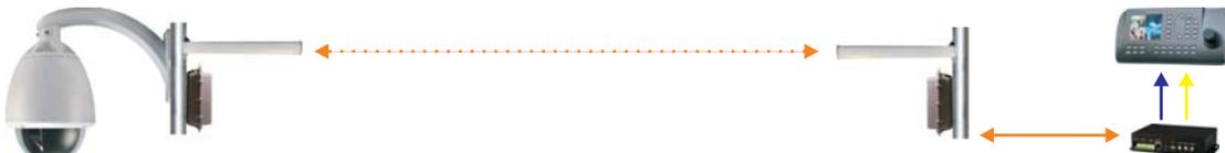
Ricetrasmisione punto-punto con antenne direzionali e AP (access point) separati, per la gestione bidirezionale di uno o più apparati connessi tra loro tramite uno switch di rete (es. videoregistratore, IP camera etc) , da remoto tramite un Pc o un network recorder (es. CENTER) fino a 20 Km
